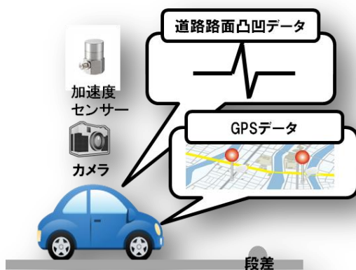
道路路面凹凸データ計測イメージ
